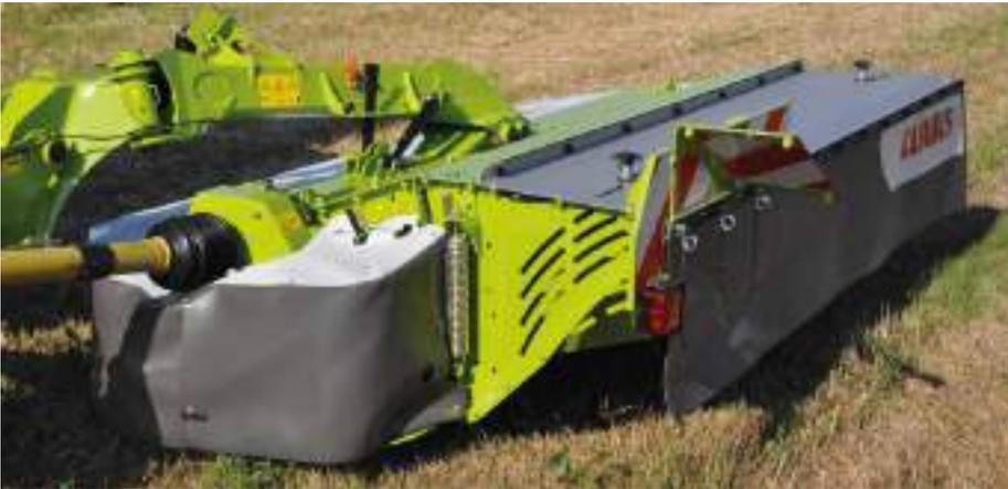
**Importante da analizzare la tipologia e la qualità del sistema di sospensione: deve permettere all'elemento falciante di scaricare al suolo solo una minima parte della sua massa. Tale regolazione va effettuata considerando la velocità di avanzamento, l'uniformità del profilo e la presenza di ostacoli.**
