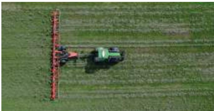
**Il voltaspandiforaggio convenzionale è lo strumento più potente a disposizione del foraggicoltore per accelerare l'essiccazione e renderla omogenea su tutta la massa di foraggio stesa sul campo. Il primo intervento, condotto su foraggio umido, produce delle lacerazioni sullo stelo che favoriscono la fuoriuscita dell'acqua (in modo simile a quelle prodotte dal condizionatore a flagelli).**
