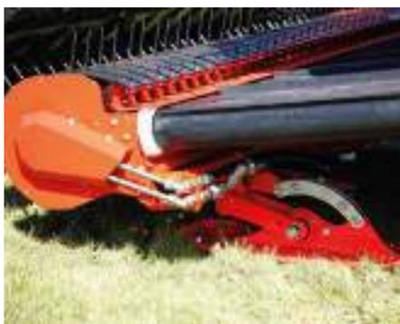
**Particolare di un andanatore a tappeto: la slitta. Questo organo regola la distanza dal suolo del dente del pick-up. È montata su parallelogramma articolato regolabile. L'attrezzatura fotografata ha un pick-up con cinque ranghi di denti e ha velocità del tappeto regolabile; il dispositivo è composto di un rullo folle a sezione esagonale e di un carter che convoglia il foraggio sul tappeto.**
